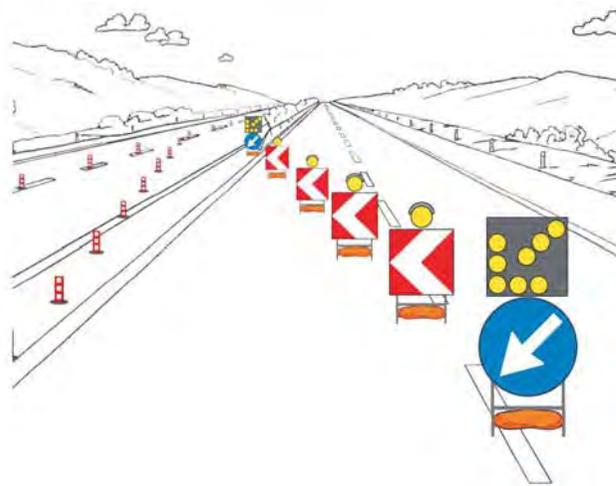
TESTATA DI SCAMBIO PER CANTIERE
