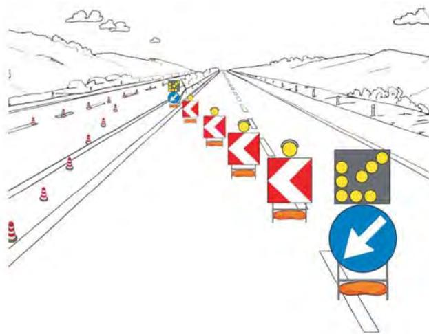
TESTATA DI SCAMBIO PER CANTIERE
