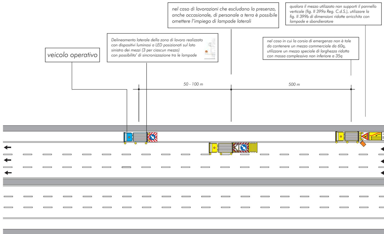
**SEGNALETICA MOBILE A PROTEZIONE DI VEICOLI SPECIALI IMPIEGATI PER LAVORI, CONTROLLI, SONDAGGI E VERIFICHE DI RAPIDA ESECUZIONE, CHIUSURA DELLA CORSIA DI MARCIA (CARREGGIATA CON CORSIA DI EMERGENZA RIDOTTA)**
