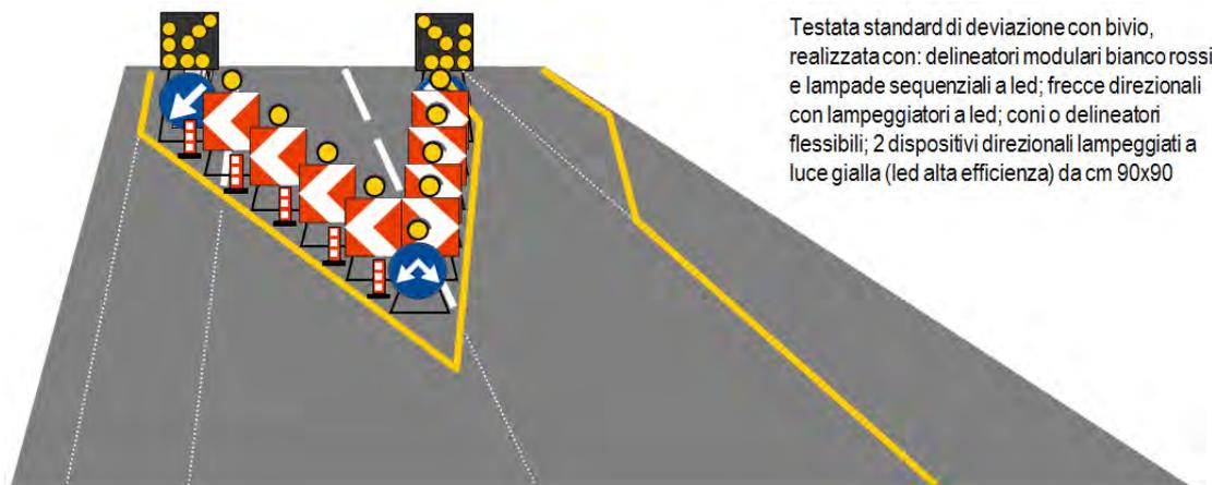
Testata standard di deviazione con bivio, realizzata con: delineatori modulari bianco rossi e lampade sequenziali a led; frecce direzionali con lampeggiatori a led; coni o delineatori flessibili; 2 dispositivi direzionali lampeggiati a luce gialla (led alta efficienza) da cm 90x90
