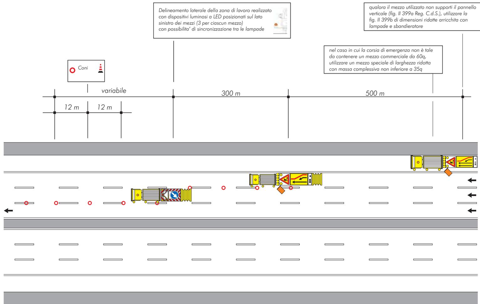
CANTIERE IN LENTO AVANZAMENTO, CHIUSURA DELLA CORSIA DI SORPASSO
