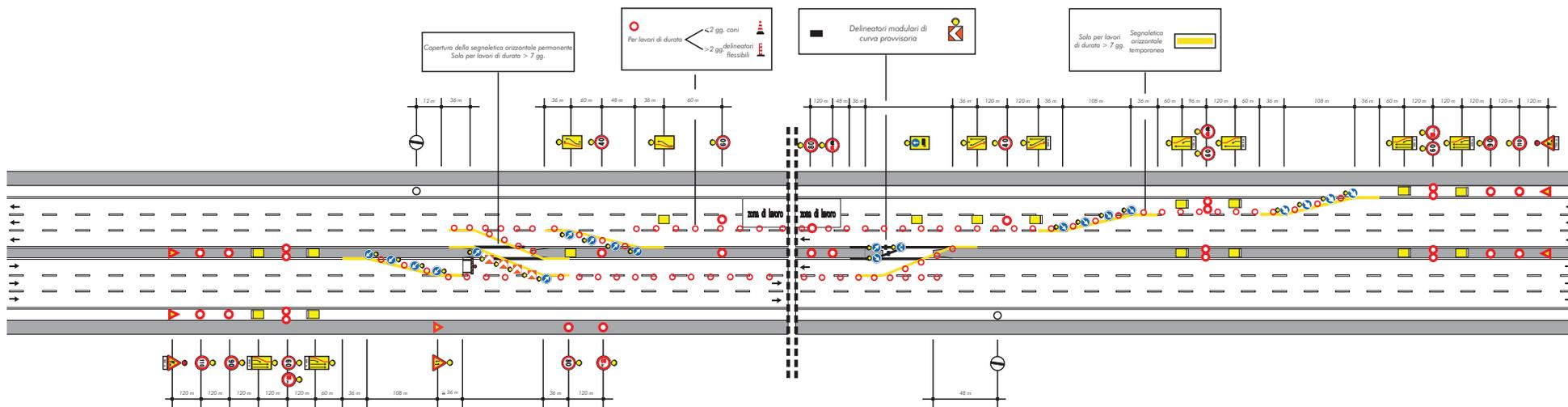
**DEVIAZIONE PARZIALE CON PRERESTRINGIMENTO, CON DUE CORSIE PER LA CORRENTE DI TRAFFICO NON DEVIATA (con presegnalamento solo in destra)**
