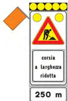
Figura 15: "presegnale di cantiere mobile" derivato dalla fig. Il 399/a Art.39 Reg., da impiegare per lavori sulla sola corsia di emergenza ridotta. E' integrato con set di 5 lampade a led ad alta efficienza luminosa diam. 200 mm (con possibilità di lampeggio sincrono e sequenziale) e con sbandiatore elettromeccanico posto in alto sul lato esposto al traffico.
