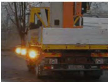
Figura 16: dotazione standard di lampade sul lato dell'autocarro esposto al traffico da utilizzare, ove richiesto dagli schemi, nei cantieri il lento movimento o in lento avanzamento.
