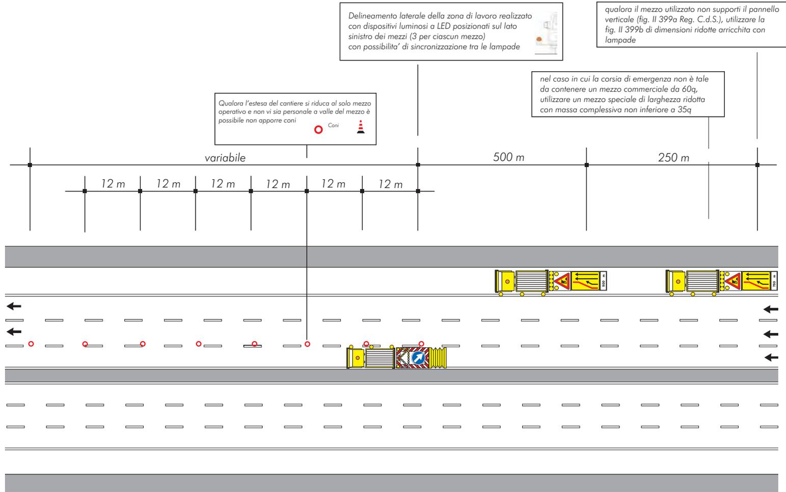
**CANTIERE IN LENTO AVANZAMENTO, CHIUSURA DELLA CORSIA DI SORPASSO CON PRESENZA ESTEMPORANEA DI PERSONALE A TERRA (CARREGGIATA CON CORSIA DI EMERGENZA RIDOTTA)**
