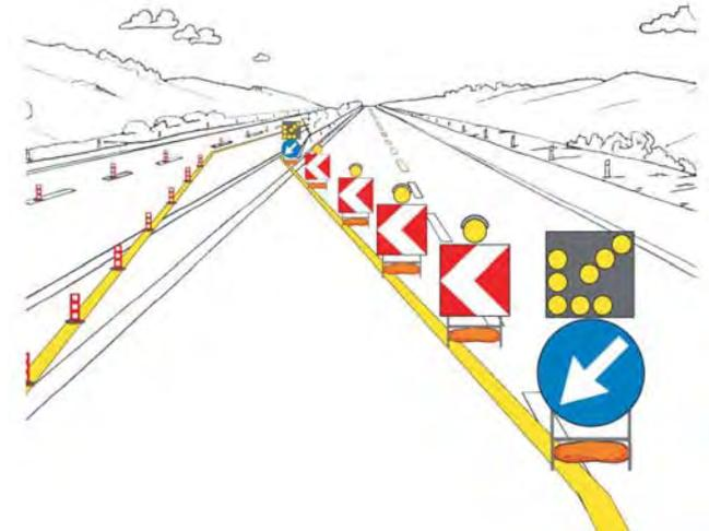
TESTATA DI SCAMBIO PER CANTIERE
