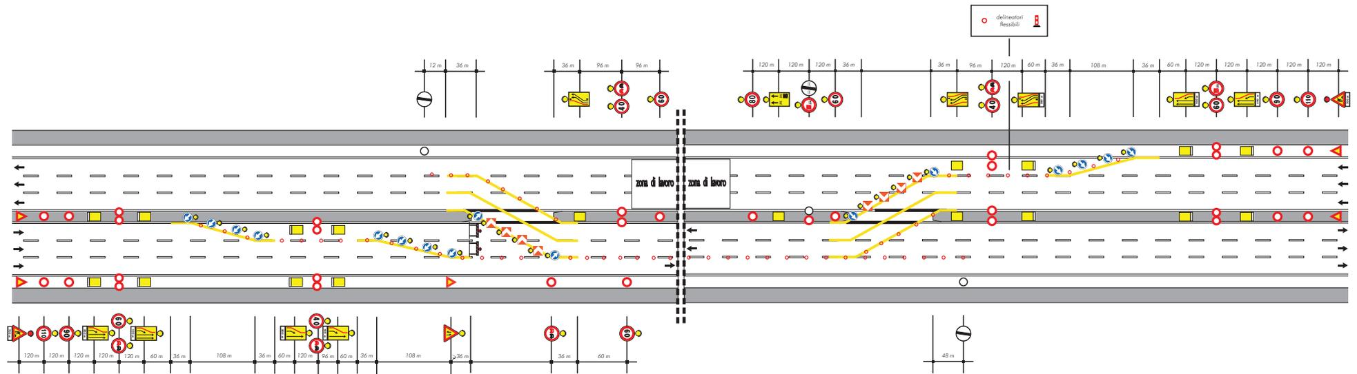
**DEVIAZIONE SU DUE CORSIE, CON UNA CORSIA PER LA CORRENTE DI TRAFFICO NON DEVIATA (PER LAVORI DI DURATA >7GG.)**
