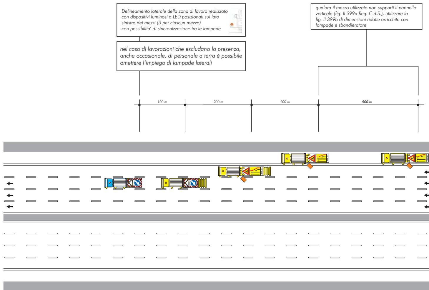
**SEGNALETICA MOBILE A PROTEZIONE DI VEICOLI SPECIALI IMPIEGATI PER LAVORI, CONTROLLI, SONDAGGI E VERIFICHE DI RAPIDA ESECUZIONE, CHIUSURA DELLA CORSIA DI SORPASSO**
